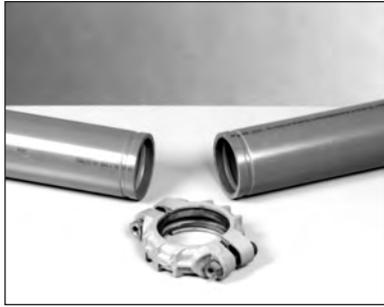
2. Verifique los extremos de la tubería para saber si hay cualquier daño, marcas del rodillo, proyecciones o muescas en la superficie exterior entre la ranura y el extremo de la tubería. Esta es el área sellante y debe estar libre de cualquier defecto.
